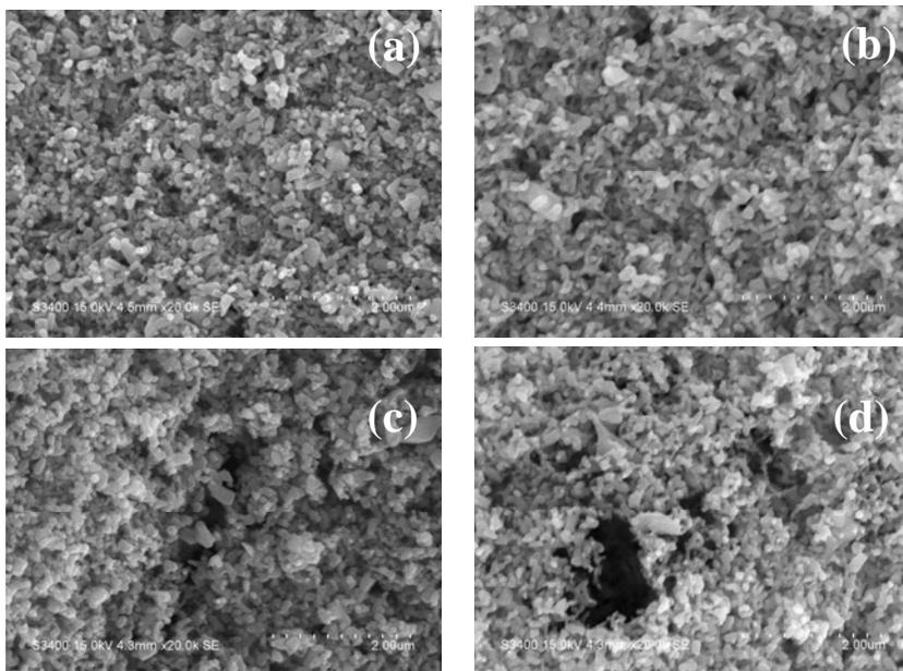
**Figure 1** SEM images of (a) bare ZnO film, (b) 0.05 wt.% MWCNTs, (c) 1.0 wt.% MWCNTs and (d) 10.0 wt.% MWCNTs
